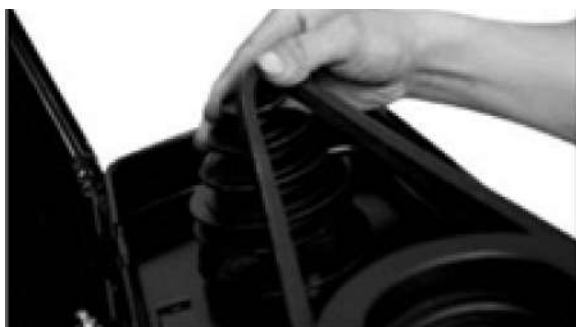
Fig. 29 – Ajuste da correia
