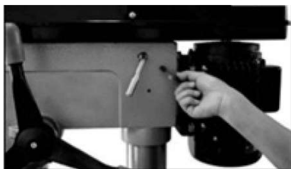
Fig. 27 – Botões de travamento da tensão da correia
